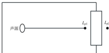
图 4.2-1 室内声源等效为室外声源图例
